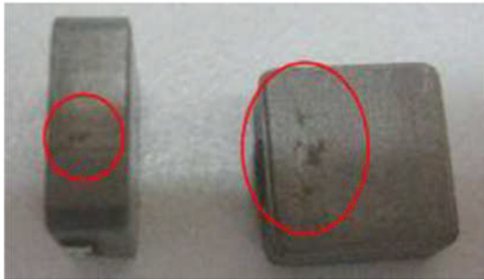
Abbildung 7: Oxidation auf dem Kern (aussortiert)
