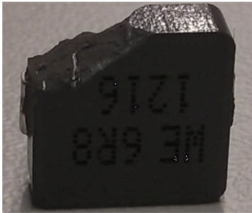
Abbildung 11: Absplitterung bei WE-LHMI 74437368068 (aussortiert)
