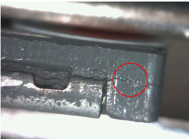
Abbildung 4: Beispiel eines nicht akzeptablen großen Risses an der rechten Anschlussseite
