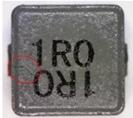
Abbildung 5: Beispiel eines nicht akzeptablen Risses an der Oberfläche
